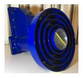
Produzido no Brasil, o *Alimentador Axial Circular Apêndice B®* foi projetado para a recepção do apêndice 30B (4.5 a 4.8 GHz) com eficiência e praticidade. Ambas as portas ficam no mesmo alinhamento axial, sendo a **Porta 1** com recepção direta e a **Porta 2** com recepção lateral nas polarizações circular à esquerda e circular à direita, diminuindo a área de sombra do alimentador na antena, possibilitando a montagem com filtros contra interferências 5G.
