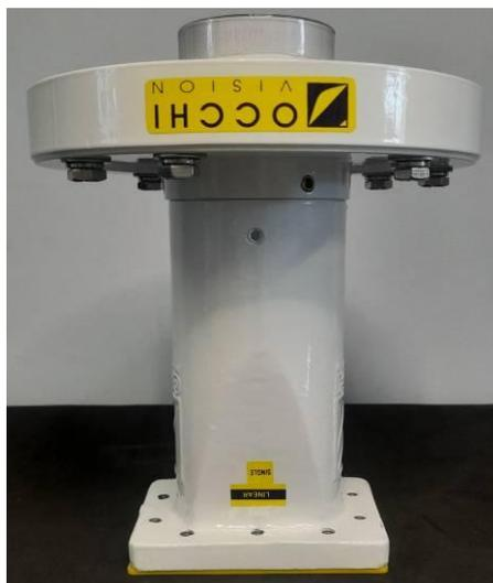
Produzido no Brasil, o **Alimentador Apêndice B® Single** foi projetado para a recepção do apêndice 30B (4.5 a 4.8 GHz) com eficiência e praticidade. A porta fica no mesmo alinhamento axial, diminuindo a área de sombra do alimentador na antena, possibilitando também a montagem com filtro.
